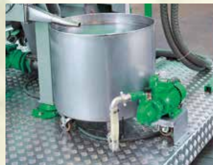
Depósito recogida de aceite - Oil-collecting tank - Réservoir de récolte de l'huile
