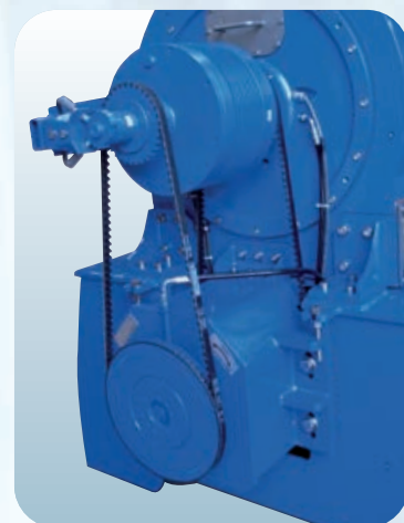
Particolare Rotovariatore e riduttore Detail of Rotovariator and reduction gear
