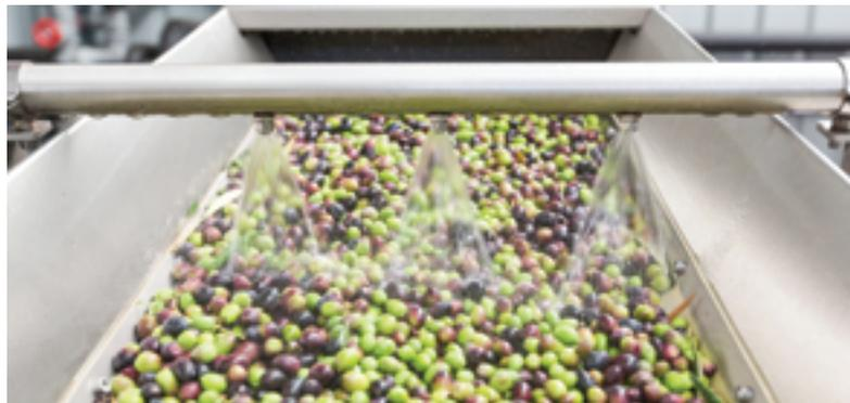
maccamenti o altre tipologie di danni della drupa. Non solo, anche per la fase di lavaggio la soluzione trovata garantisce la massima cura del processo, la cui peculiarità sta proprio nell'aria che mantiene continuamente in sospensione l'oliva nell'acqua permettendone così la pulizia ed evitando contatti violenti con la macchina. Senza contare che tutti i componenti a contatto con il prodotto sono realizzati in acciaio inossidabile per assicurare la massima solidità, affidabilità ed igiene”.
