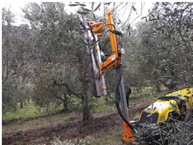
A sinistra, macchine potatrici radiocomandate a distanza con lame a dischi e, sopra, piante di olivo allevate a vaso policonico potate a macchina
