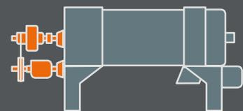
Giri differenziali variabili con regolazione automatica (motore idraulico)
