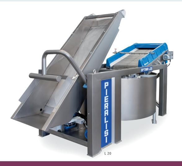
Le système de lavage spécial de la laveuse hydropneumatique pour olives Pieralisi assure l'élimination totale du terreau attaché aux olives ainsi que la séparation de tout corps étranger. La consommation d'eau est donc limitée puisque l'eau, lors de sa circulation, dépose tous les déchets transportés ; par conséquent, il y a la possibilité d'opérer toujours avec de l'eau propre dans la cuve de lavage.
